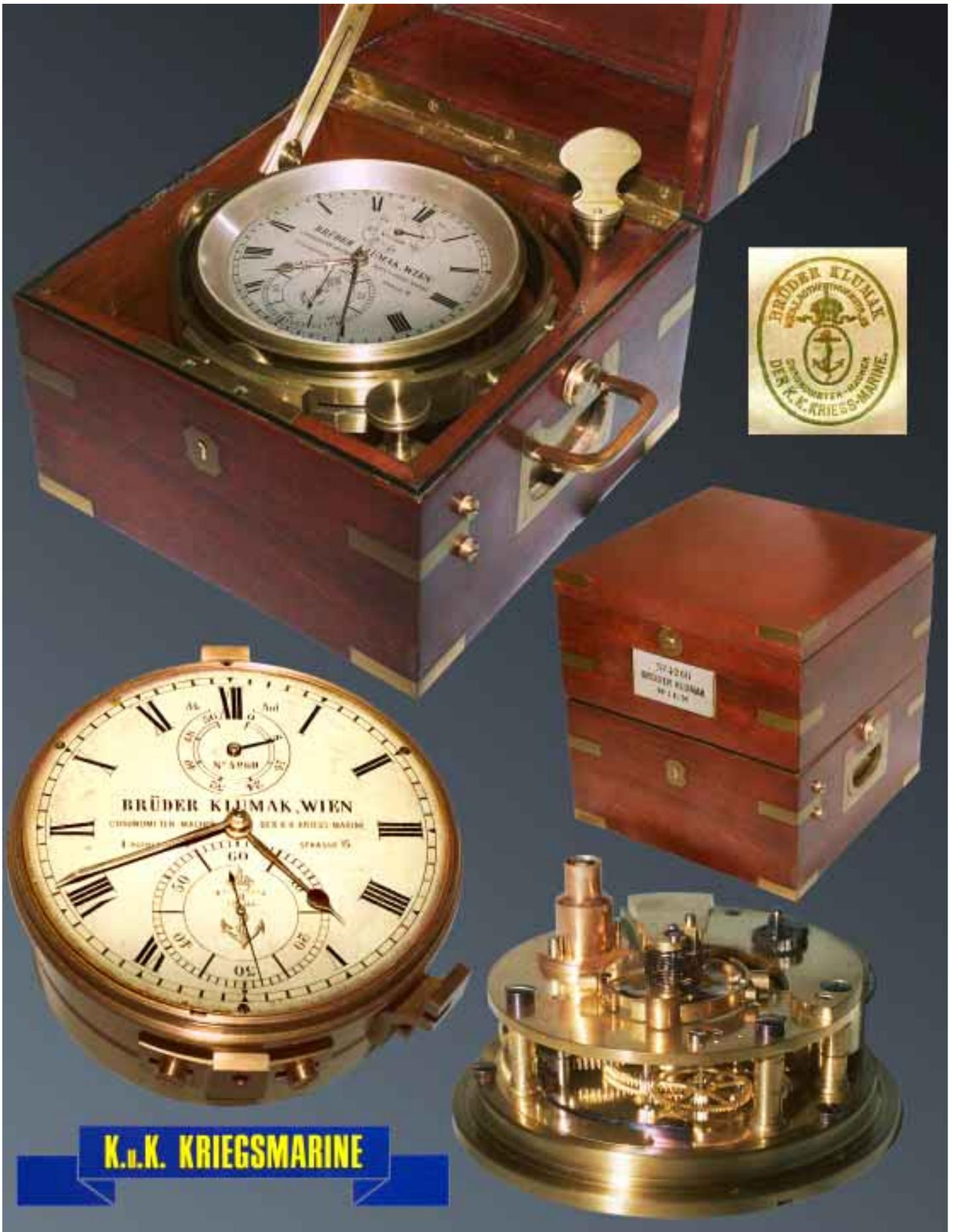
Brüder Klumak Wien, No. 4620, ca. 1870, Marinechronometer für die k.u.k. Kriegsmarine mit 56 h Auf- und Abwerk, Mahogany-Kasten, Kardanaufhängung, Schnecke/ Kette Messingwerk mit gebläuten Schrauben. Chronometerhemmung mit Feder, Kompensations-Unruh mit Gewichten und Schrauben, zylindrische Unruhfeder.
