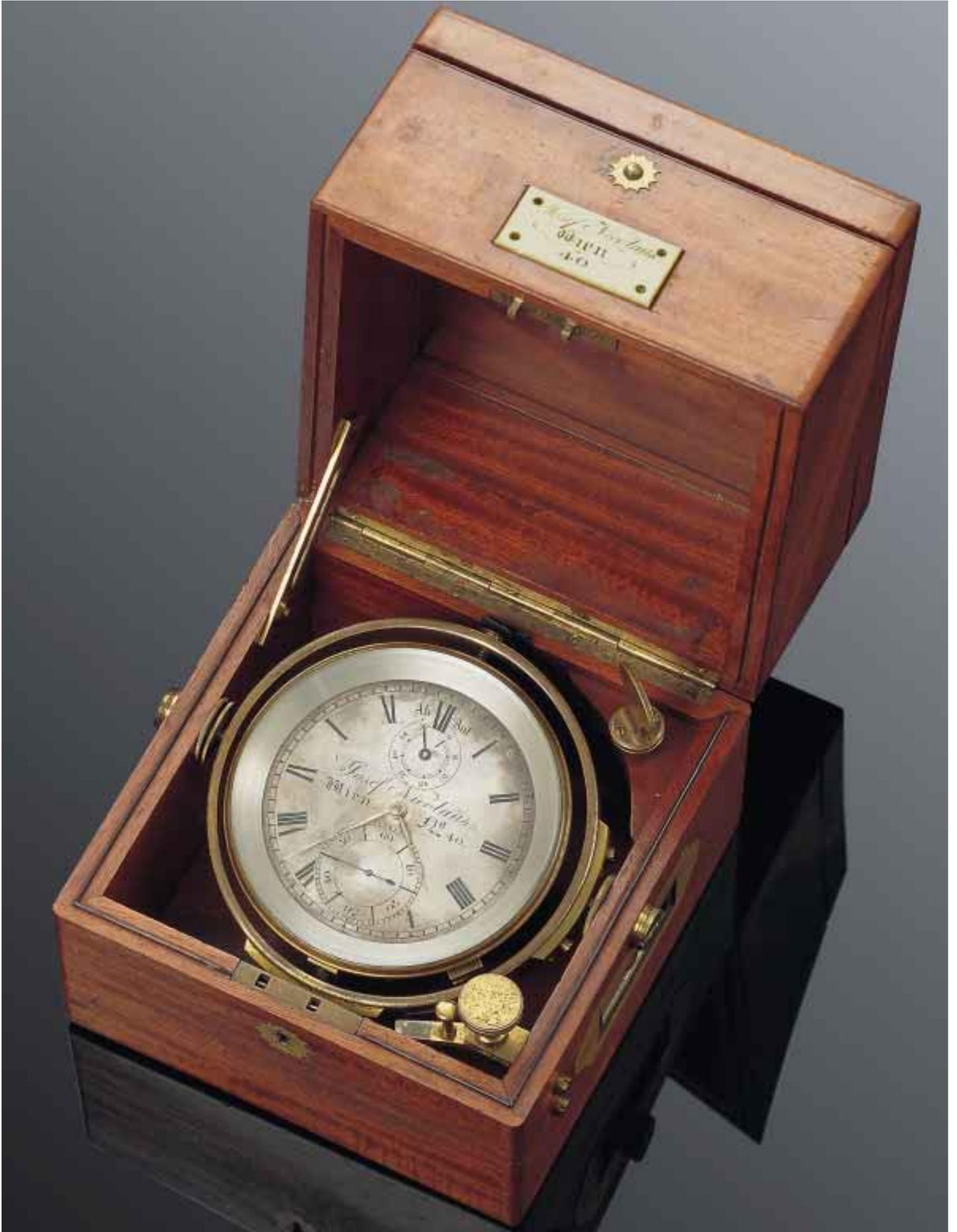
Josef Nicolaus Wien Nr. 40 um 1880, Marine-Chronometer mit 56 h Auf- und Abwerk, Mahagony-Kasten mit Elfenbeinschild, Kardanaufhängung, Schnecke/Kette Messingwerk mit gebläuten Schrauben, Chronometerhemmung mit Feder, Kompensations-Unruh mit Gewichten und Schrauben, zylindrische Unruhfeder und Diamantdeckstein. (Crott/Muser).
