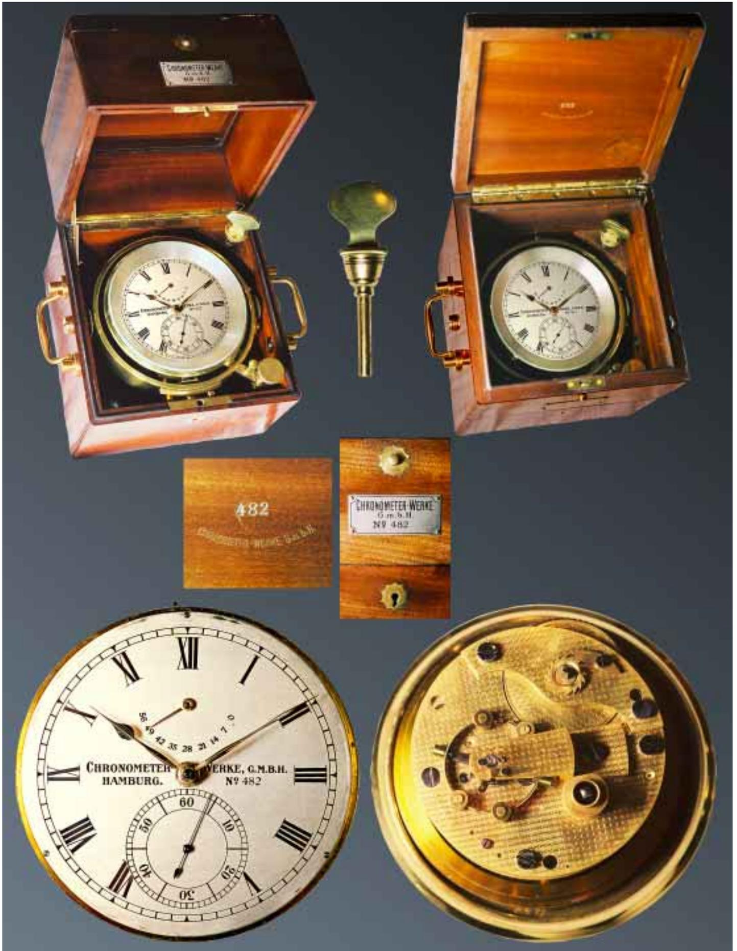
Seechronometer für die Kaiserliche Marine: - Chronometer Werke Hamburg Nr. 482 mit springender Gangreserve-Anzeige, Baujahr 1911, Richard Griesbach Unruh. Die Gangdaueranzeige umfasst etwa 160°, 0 - 56 Stunden, Chronometerhemmung. Charakteristisch ist die sichtbare Werkplatine unter der Zifferblattplatine.
