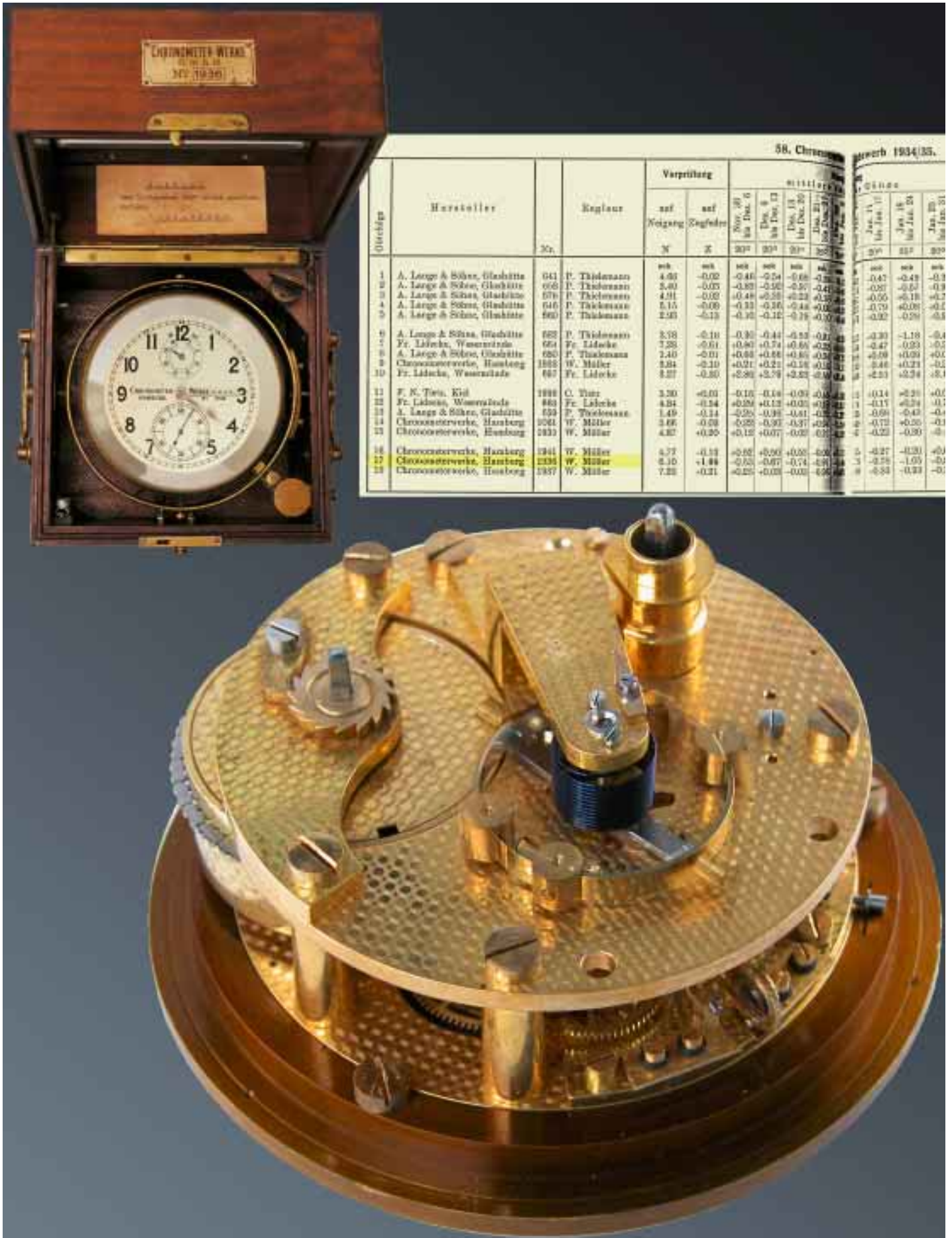
Chronometerwerke Hamburg G.m.b.H.: - Marine-Chronometer Nr. 1936, getestet bei der Deutschen Seewarte 1934, im 2-teiligen verglasten Eichenholzkasten, Hamburger Rohwerk, Federhemmung, Kette/Schnecke, Messingtopf und -Kardanring', Anschlüsse für Elektrokontakte vorn. Chronometer Werke G.m.b.H. Hamburg: - ship's chronometer no. 1936, tested at the deutsche Seewarte 1934, spring detend, brass casing and gimbals, electrical contacts for second triggering.
