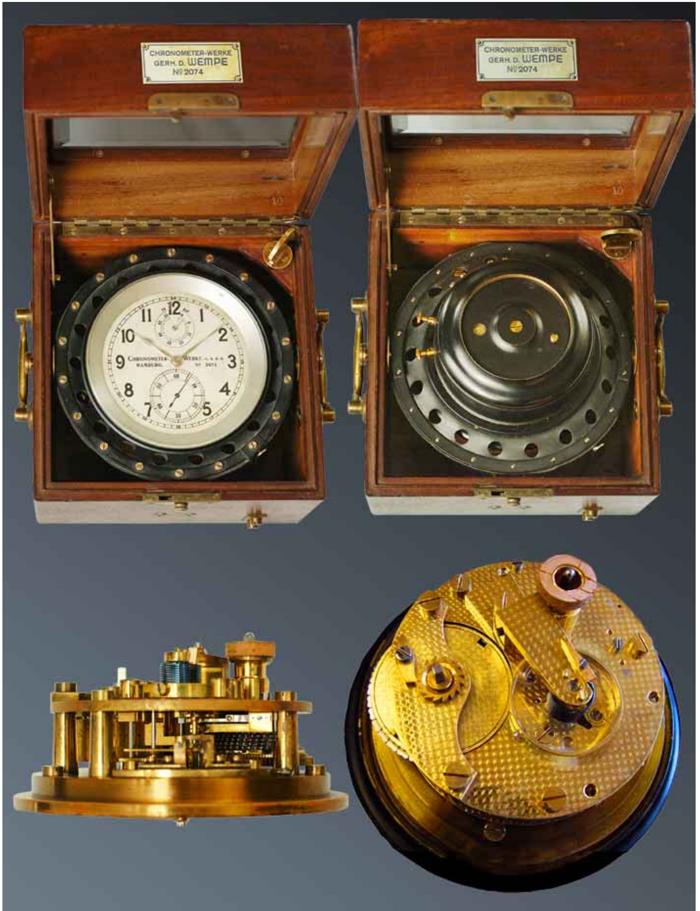
Chronometerwerke Hamburg G.m.b.H.: - Luftwaffen-Chronometer Nr. 2074, Bauj. 1937 bevor Herbert Wempe die Firma übernahm, im 2-teiligen verglasten Eichenholzkasten, Hamurger Rohwerk, Federhemmung, Kette/Schnecke, geschwärtzter Messing-Glasring und -Topf im gelochten Metallgummi-Ring drehbar um eine Achse ('3-9'), Arretierung über Federhalter bei der '5', Anschlüsse für Elektrokontakte vorn.
