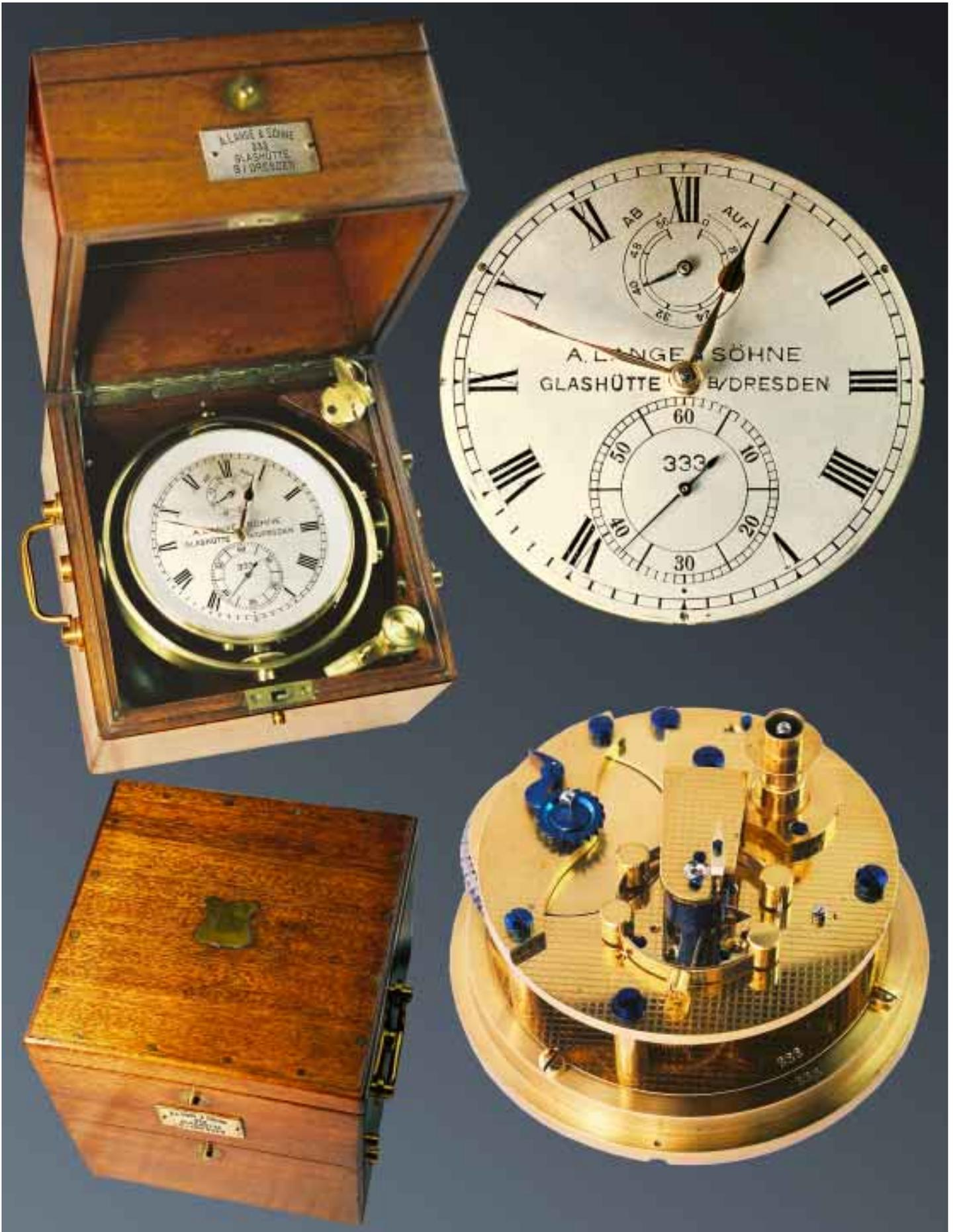
Marinechronometer A. Lange & Söhne Glashütte B/Dresden Nr. 333, geliefert an die Fa. Ludolf in Bremerhaven am 15.7.1919, Messingteile vergoldet und dekoriert, Stahlteile gebläut, 4 Pfeiler, Federhaus/Schneckenrad, saphirchatonierte Lager, Chronometerfeder und Chronometerrad, AL&S-Integralunruh und Diamantdeckstein. (Privatbesitz, Fotos K. Knirim Dez. 2002)
