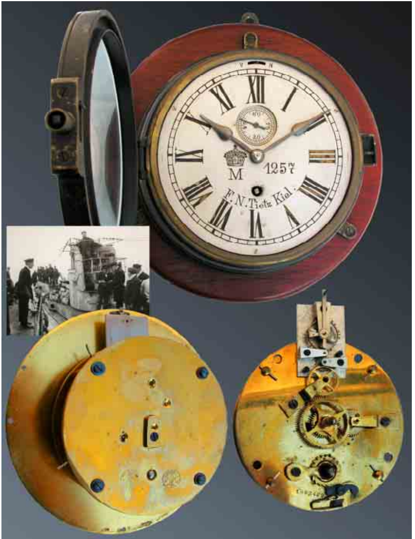
Schiffswanduhren der Kaiserlichen Marine: - F. N. Tietz Kiel, Nr. 1892479, Gehäuse, Zifferblatt, Werk und Hemmung nummerngleich, Gehäuse aus Messing, Reichskrone M 1257, massives Messingzifferblatt Messingwerk, mit Schraubenunruh, Breguetspirale und Malteserkreuz, 8-Tage-Werk von Gustav Becker aus Freyberg in Schlesien. Foto: Torpedoboot beim Lancieren.
