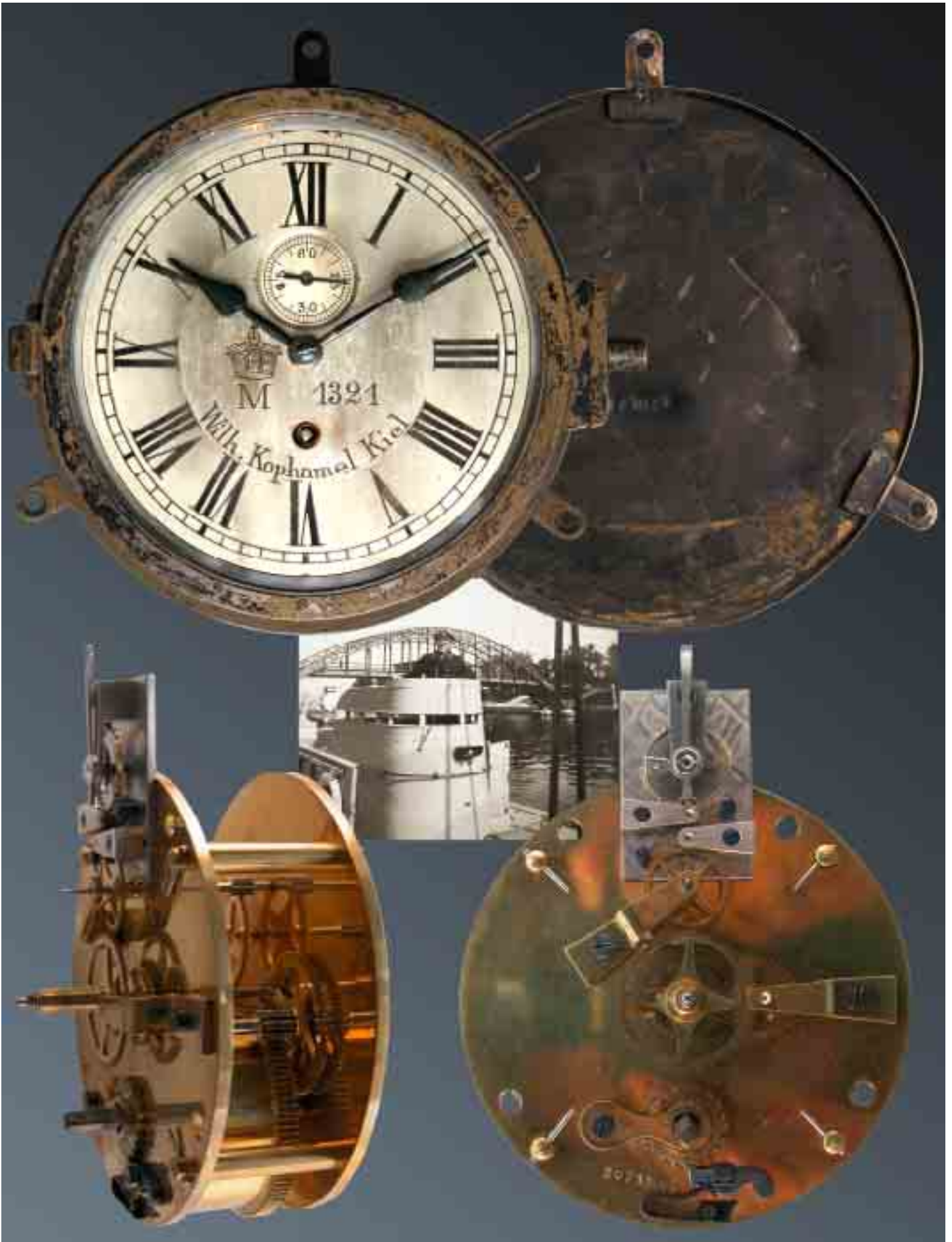
Schiffswanduhren der Kaiserlichen Marine: - W. Kophamel Kiel, Schiffswanduhr M 1321.Nr. 2071337 Gehäuse, Zifferblatt, Werk und Hemmung nummerngleich, massives Messingzifferblatt Messingwerk, mit Schraubenunruh, Breguetspirale und Malteserkreuz, 8-Tage-Werk von Gustav Becker aus Freyberg in Schlesien. Foto: Torpedoboot im Kaiser-Wilhelm-Kanal.
