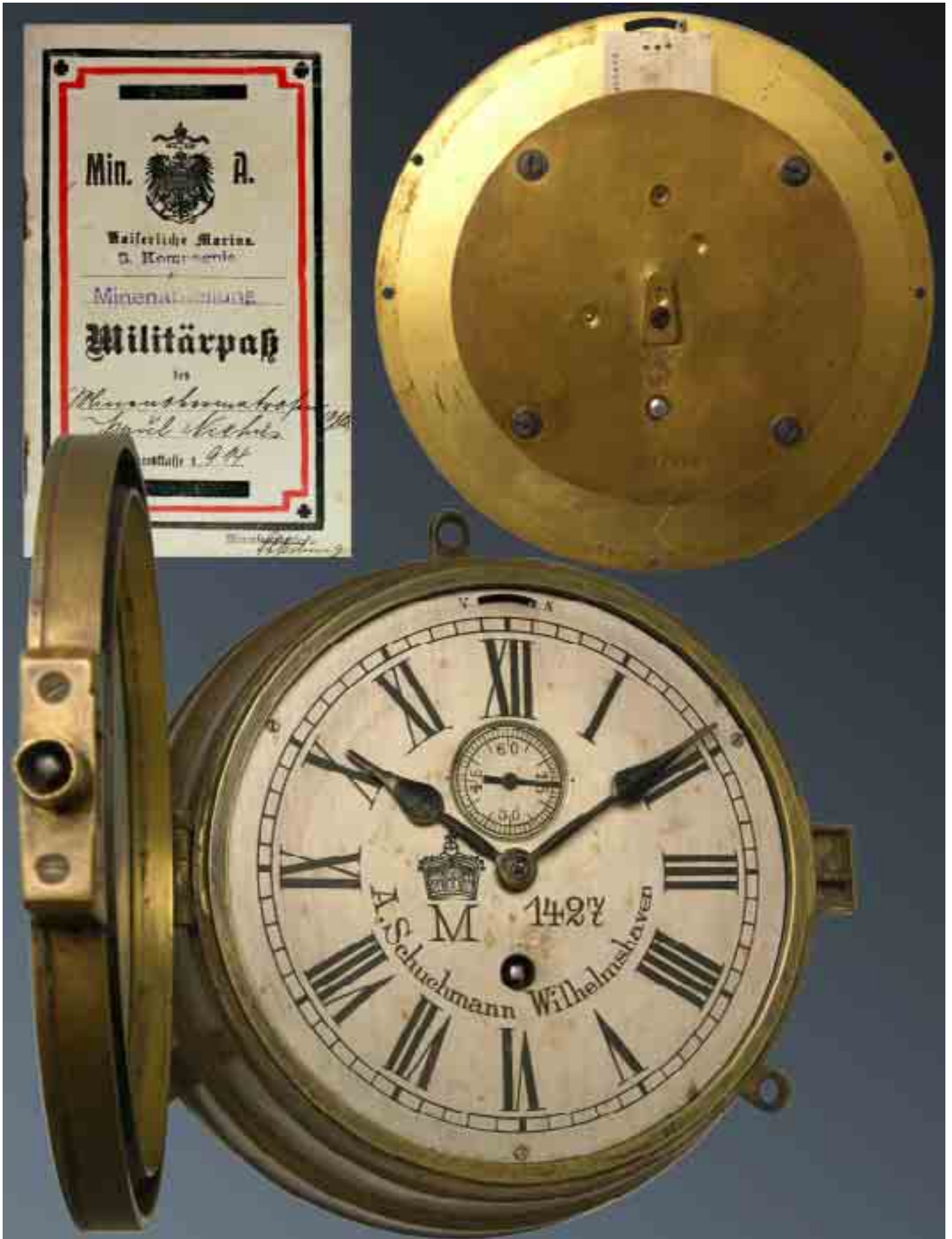
Schiffswanduhren der Kaiserlichen Marine: - A. Schuchmann Wilhelmshaven, Schiffswanduhr M 1427.Nr. 2071473 Gehäuse, Zifferblatt, Werk und Hemmung nummern- gleich, massives Messingzifferblatt Messingwerk, mit Schraubenunruh, Breguetspirale und Malteserkreuz, 8-Tage-Werk von Gustav Becker aus Freyberg in Schlesien. Ship's Wall Clocks of the Imperial Navy: - W. Kophamel Kiel, all parts numbered no. 2071473, brass case, with Imperial Crown and navy number M 1427, 8-day movement no. 2071337by Gustav Becker of Freyberg in Silesia.
